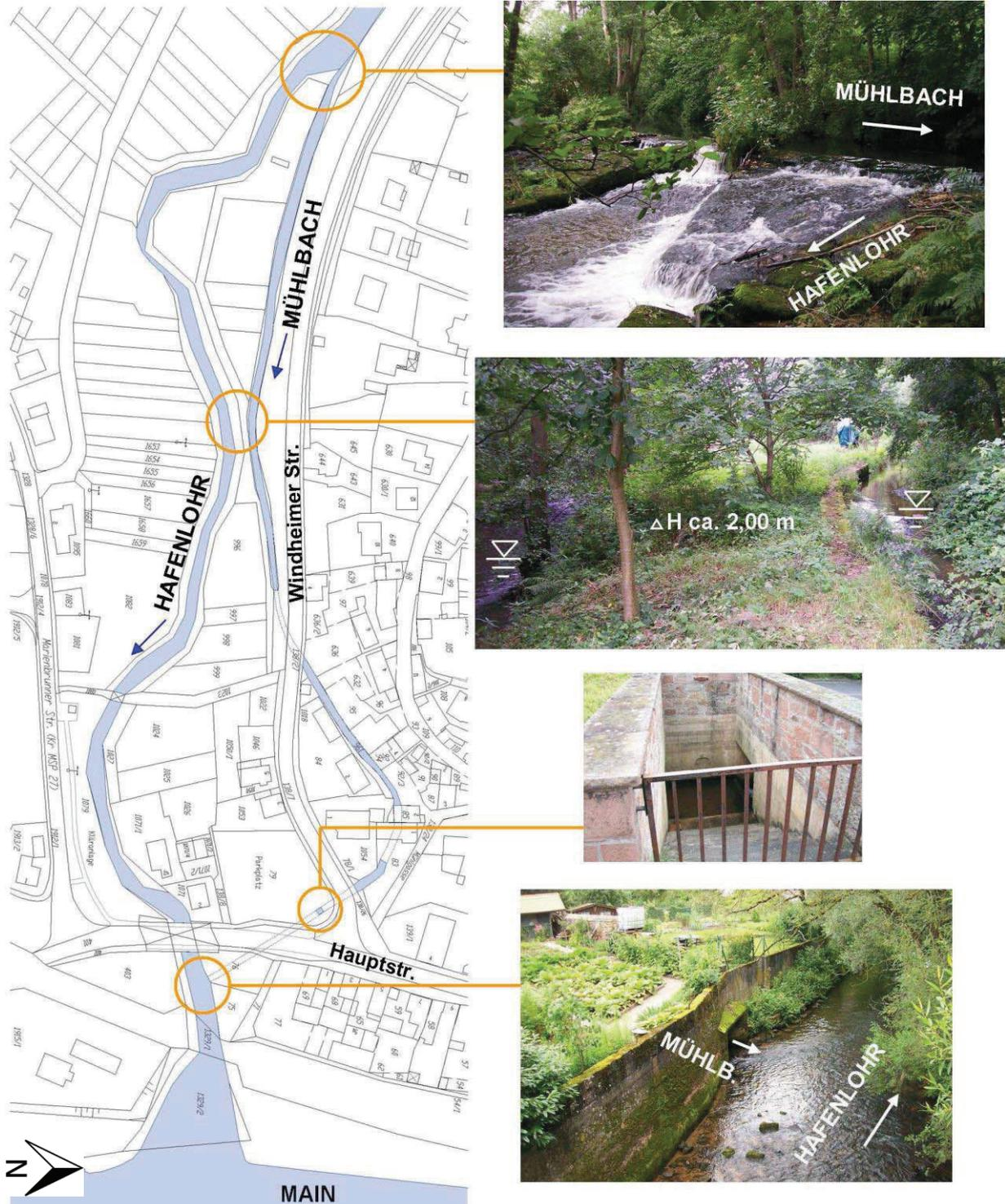
Der Mühlbach fließt als Seitengewässer der Hafenlohr in die Ortslage zu einer ehemaligen Mühle und dann wieder zurück in die Hafenlohr. Auf diesem Weg kreuzt er die Windheimer Straße in einem Durchlassbauwerk (Stahlbetonrohr) und die Ortslage in teilweise offenem und geschlossenem Gerinne (Rahmenprofil). Er kreuzt nach der Mühle wieder die Windheimer Straße und dann die Hauptstraße, bevor er unter einem Gartengrundstück in die Hafenlohr mündet (siehe Abbildung 4).
